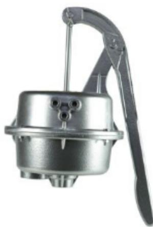
Viene utilizzata per il riempimento di acqua della pompa orizzontale, manovrando l'apposita leva, si ottiene l'evacuazione dell'aria dal tubo di aspirazione, permettendo in modo automatico il riempimento della pompa. È costruita in alluminio con membrana in gomma.
