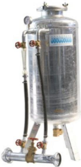
Consiste in un serbatoio di metallo zincato a fuoco, che permette la penetrazione di quantità controllate di fertilizzanti nell'acqua.
